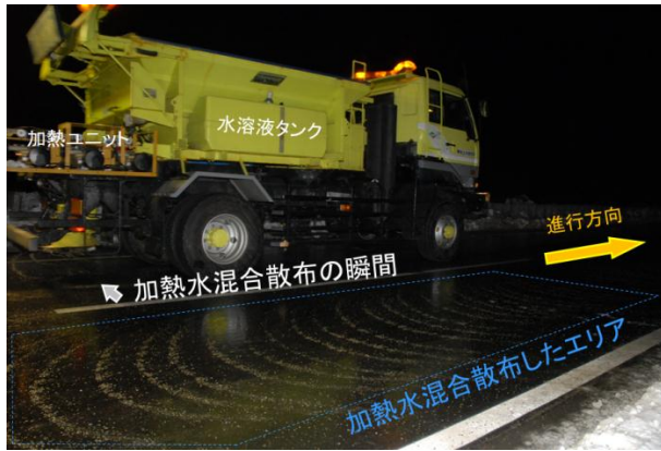
写真-3 試作機による散布状況
