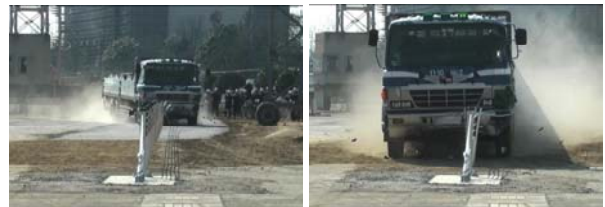
写真6 防護柵衝突後の大型貨物車の軌跡
