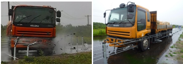
写真3 衝突実験時(左)と衝突後(右)の状況
