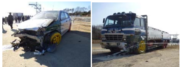
写真7 衝突後の車両破損状況
