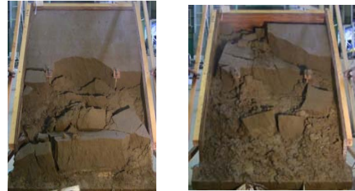
写真－2 中央2点補強の崩壊状況
