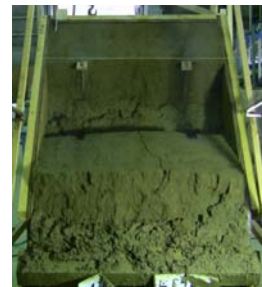
写真－3 上部2点補強の崩壊状況
