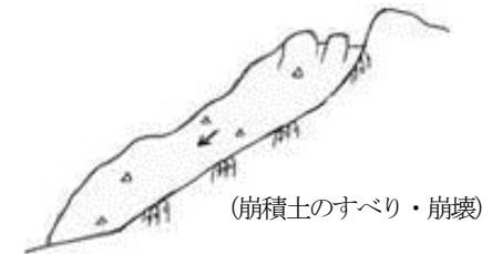
図-5 変状パターン(1)模式図
