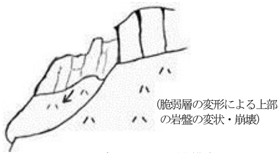
図－8 変状パターン(4)模式図
