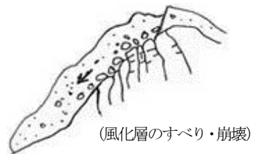
図-5 変状パターン(1)模式図
