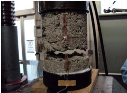
写真-1 直接引張試験 (破断後)
