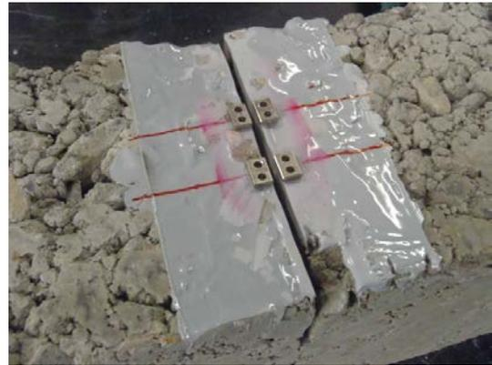
写真-2 切り欠き部エポキシ補強状況
