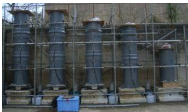
写真-1 大型カラム試験装置
