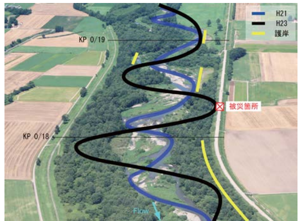
図-5 出水前後の流路線形と護岸箇所（撮影 H21.9）
