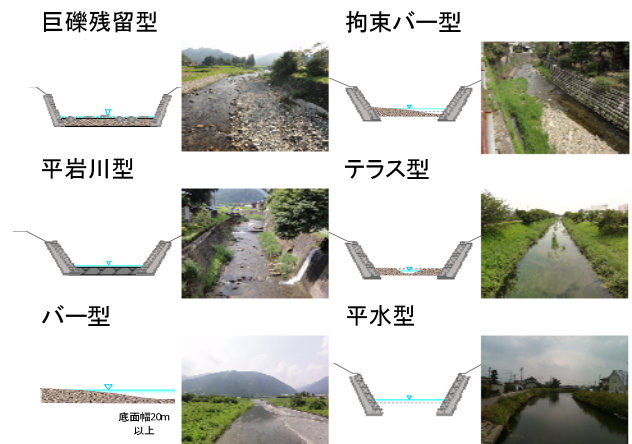
図-2 河道タイプ (模式図とイメージ写真)
