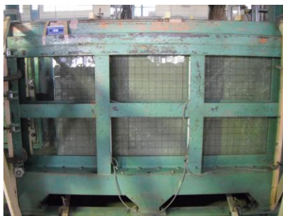
写真-1 補強土壁模型
