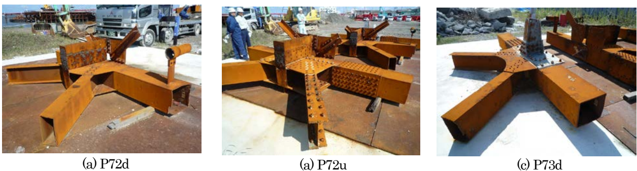
図-2.2.2 塗膜除去後の試験体
