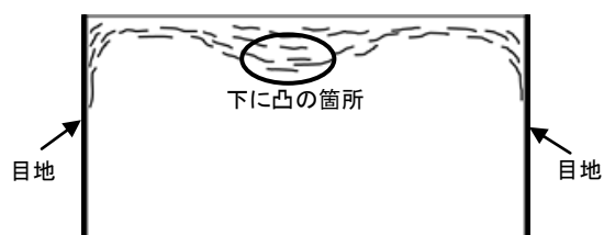
図-14 凍害による開水路側壁のひび割れ分布の一例
