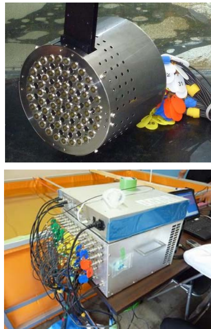
図-2 音響プローブ（上）とパワーアンプ（下）
