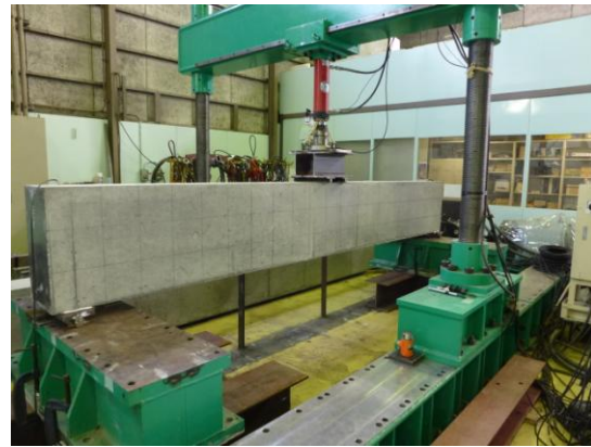
写真-3.2 実験状況 (梁供試体の曲げ載荷試験)
