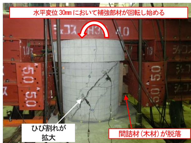
写真-5.3 応急復旧後の载荷実験の状況(支承1側)
