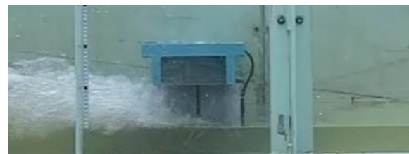
(b) 津波高20cm (上：計測波形，下：流況写真)
