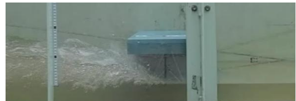
(a) 津波高15cm (上：計測波形，下：流況写真)
