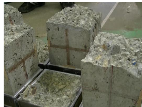
(d) 供試体破断状況 (角柱供試体)
