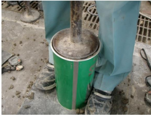
写真-3 円柱供試体 (φ150×L300) 作製状況
