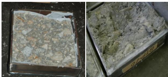
(a)接着剤不足状況(b)治具内破断状況
