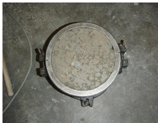
写真-6 一面せん断試験用の供試体作製状況 （ \phi 200 \times L200 ）
