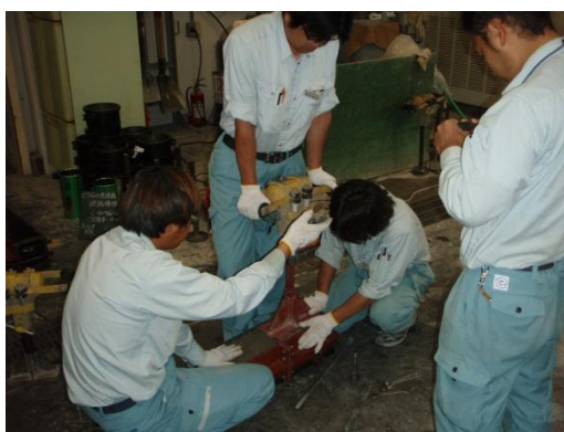
写真-7 破壊エネルギー試験用の供試体作製状況 (□150×L530)
