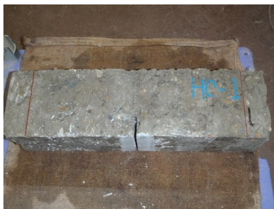
写真-9 切欠き部の平滑処理
