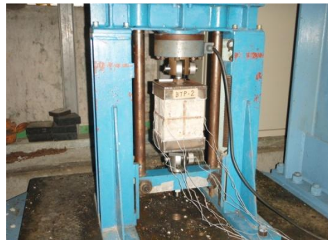
(c) 試験状況 (角柱供試体)
