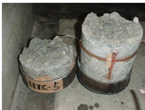
(b) 供試体破断状況 (円柱供試体)
