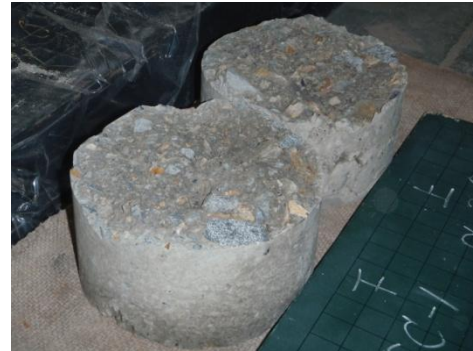
(b) 供試体破断面
