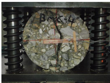
(b)割裂破断状況
