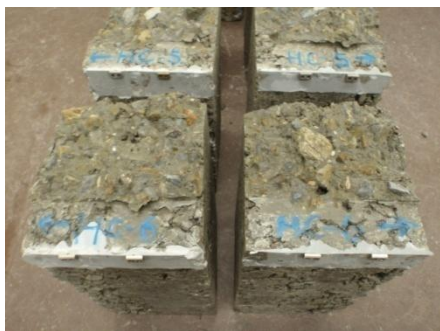
(b) 供試体破断面
