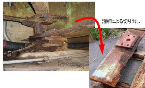
写真-2.1 腐食欠損試験体の撤去前状況
