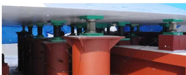
写真-2.4 伝達衝撃力計測用ロードセル
