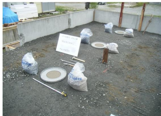
写真-2.3 砕石緩衝材の締固め密度の計測状況
