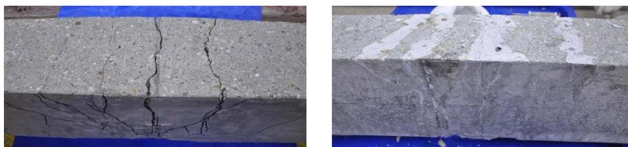
写真-3.2 ひびわれ補修状況
