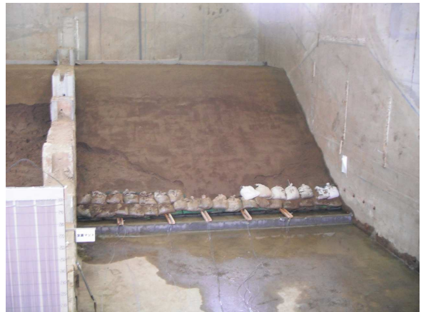
写真8 のり尻部の浸透崩壊（排水マット有り）
