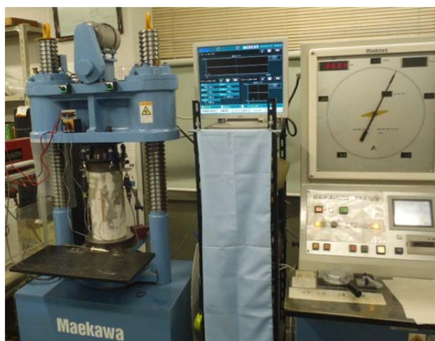
写真-2.2 圧縮強度試験状況
