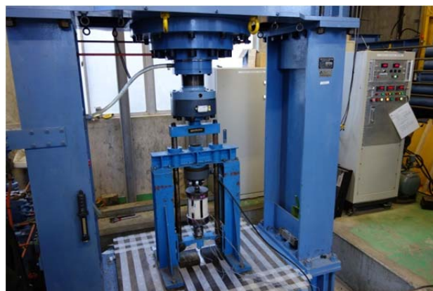
写真-2.6 急速載荷での直接引張試験
