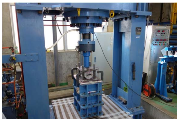
写真-2.5 急速載荷での割裂試験
