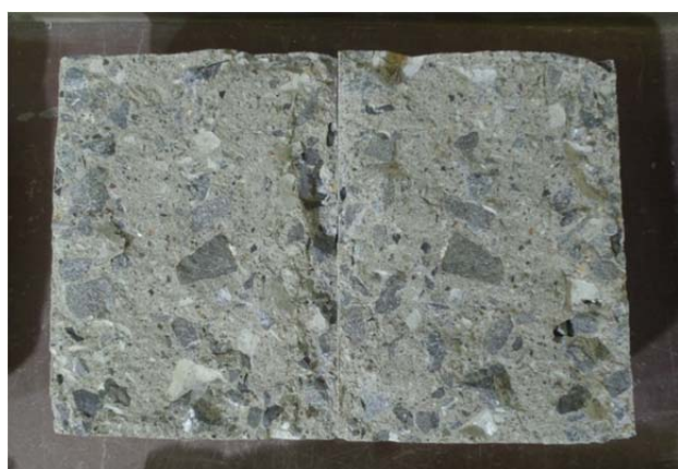
(c) 供試体破断面
