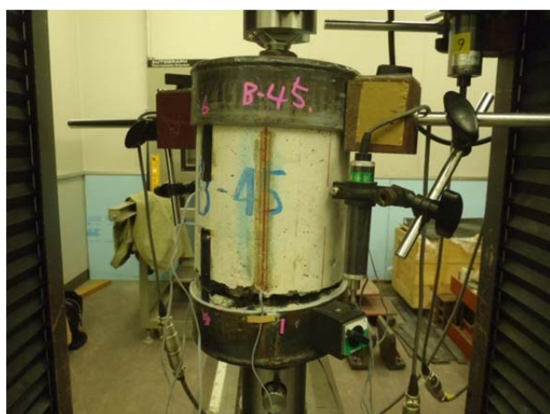
(b) 供試体破断状況
