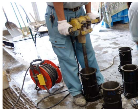
写真-2.1 供試体作製（タンパ締固め）状況
