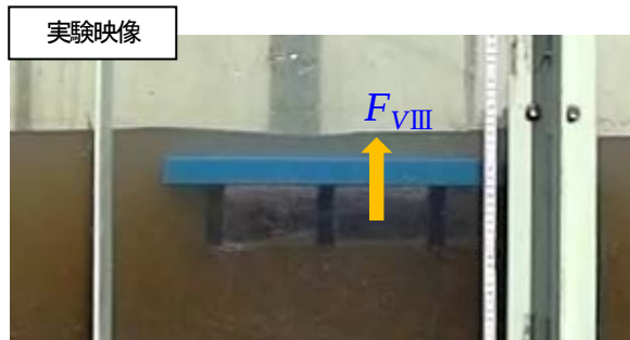
図-3.3 津波が橋桁の上を通過している段階の流況と桁に生じる力の関係（状態Ⅲ）
