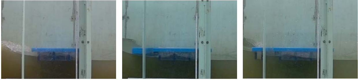
(a) 津波が本橋主桁の中間まで達したときの流況
