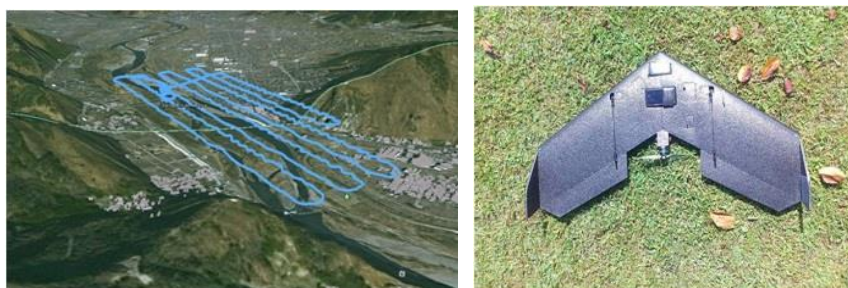
図-10 UAV の撮影航路及び撮影に用いた小型 UAV
