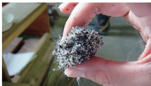
図-5 短繊維による砂粒子の緊縛状況 ( r_m=1.456\% )
