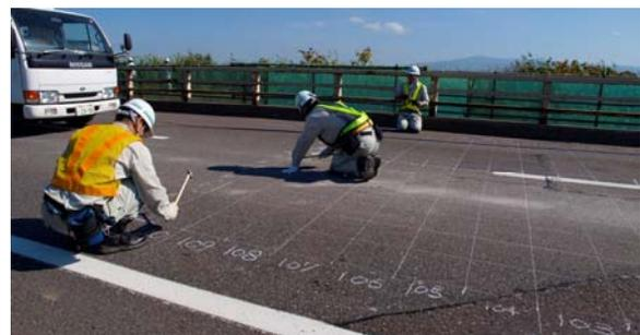
写真-3 現地調査の様子（舗装上面からの打音）
