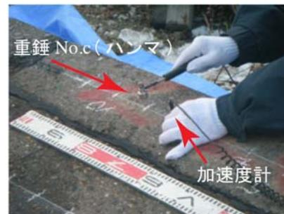
図-18 衝撃弾性波試験状況
