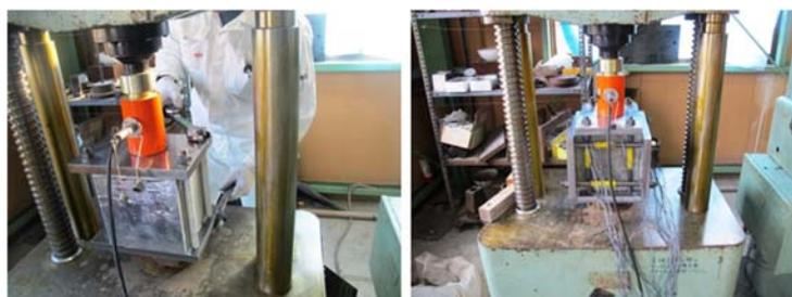
写真-2 試験体応力導入状況
