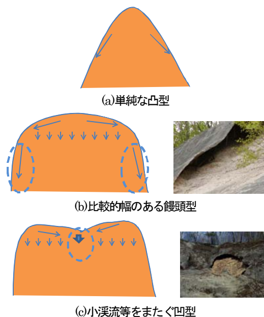
図3 吹付のり面形状と吹付背面の地山境界部の水の流れと被災パターン
