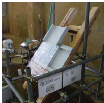
(a) 実験状況（鉛直ひび割れ）
