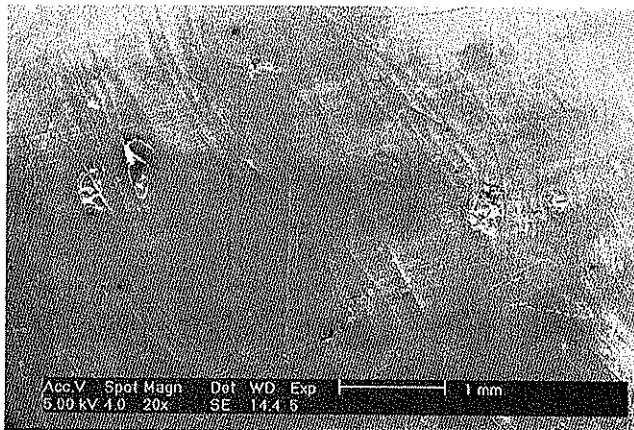
図-7 高湿度劣化試験後の外観(SEM) (Type2,60°C85%210 日間)
