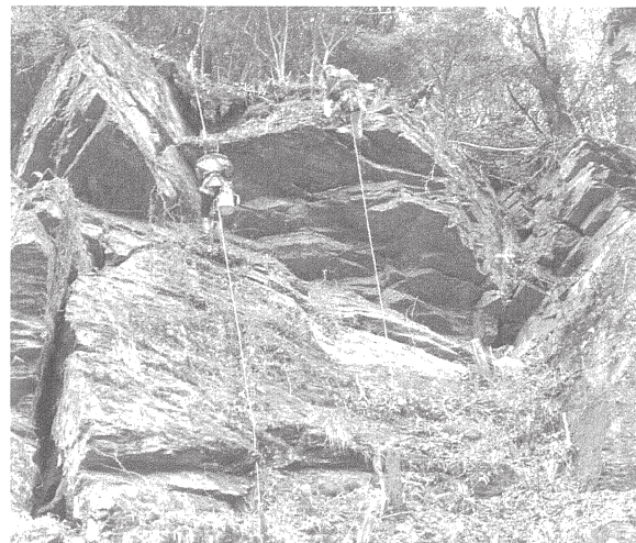
写真-2 岩盤斜面への振動計設置作業
