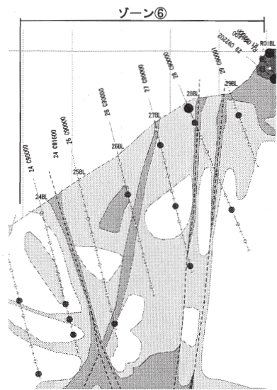
図 4-7 岩級区分とチェック孔 (Gダム ゾーン⑥)
