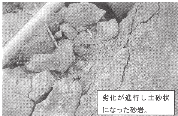
図-5 劣化した割ぐり石の例
