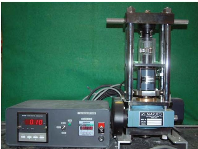
写真4.1 小径コア専用小型試験機
