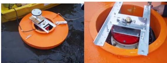
図 2-2-3 ジンバル機構を搭載したフロート
