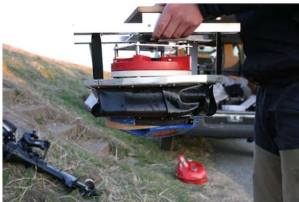
図 2-2-2 作成したジンバル機構
