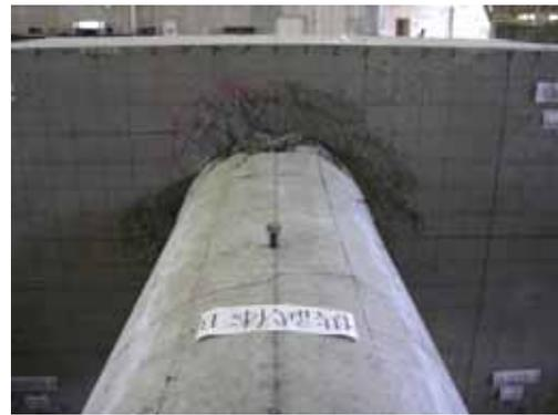
写真 - 4.1 供試体損傷状況 (Case 1)
