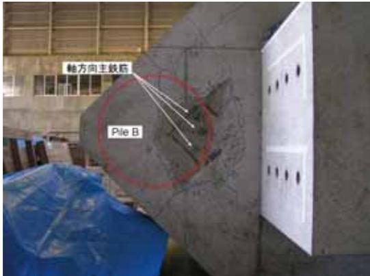
写真 - 4.3 フーチング上面の損傷状況 (Case 3)
