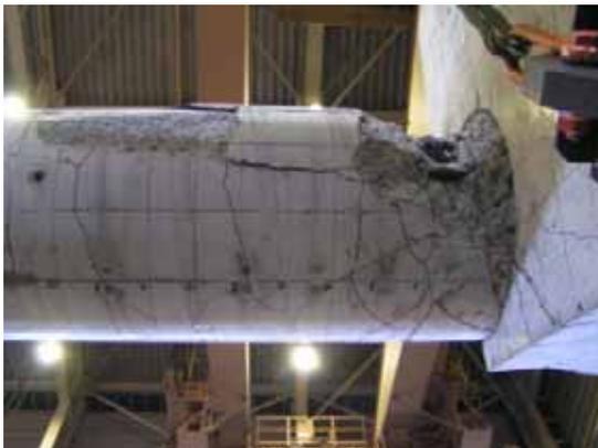
写真 - 4.4 杭体の損傷状況 (Case 3)
