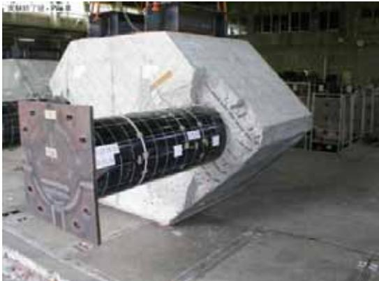
写真 - 4.5 フーチング下面損傷状況 (Case 4)
