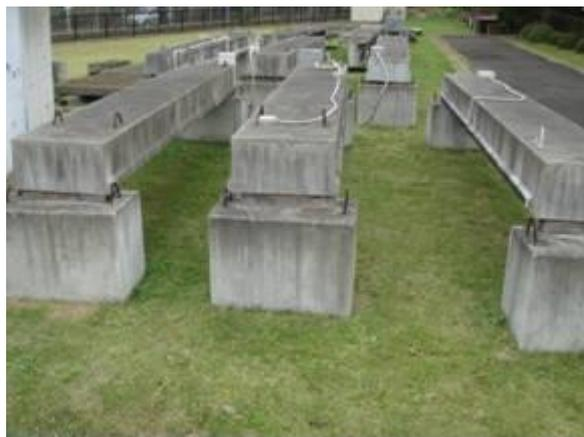
写真-8.1 電気防食大型試験体の暴露状況(つくば)
