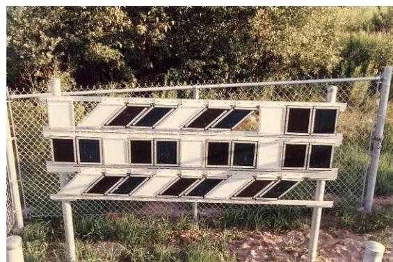
写真-7.3 CFRPシート供試体の暴露状況(シェルブルック)
