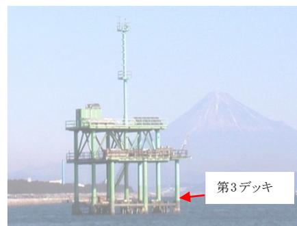
写真-4.1 塩害供試体の暴露環境
