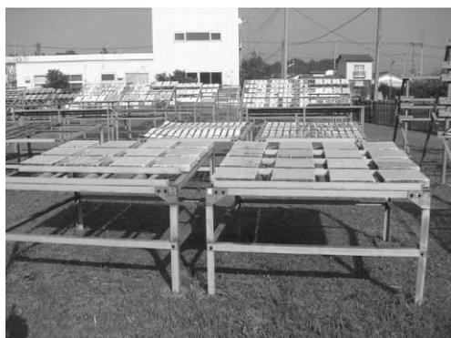
写真-7.4 供試体の屋外暴露試験状況（シリーズ1）
