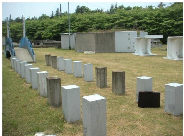
写真-5.1 ASR供試体の暴露状況
