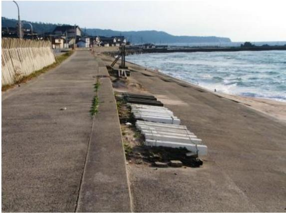
写真-6.1 AS R供試体の暴露状況
