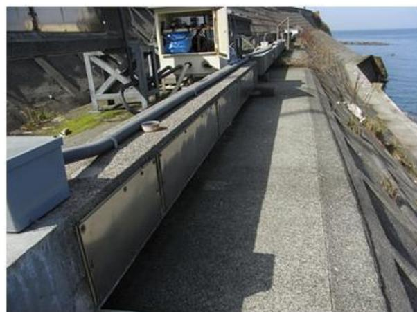
写真-8.3 電気防食大型試験体の暴露状況(親不知)
