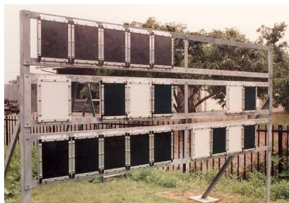
写真-7.1 CFRPシート供試体の暴露状況(つくば)
