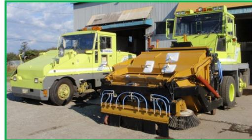
写真-5 路面清掃車(左)と試行した試作機(右)
