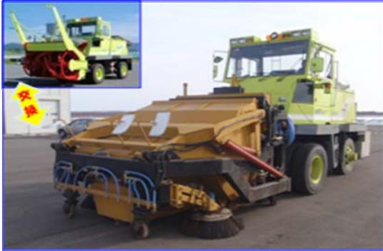
写真-1 ロータリ除雪車に対応した路面清掃装置（試作機）
