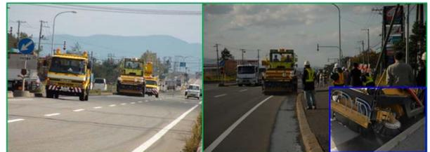
写真-6 試作機の清掃状況
