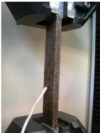
図-7 引張り試験の様子 (ジュートを用いた例)
