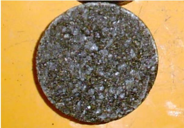
図-3 ロジン系バインダを用いた混合物
