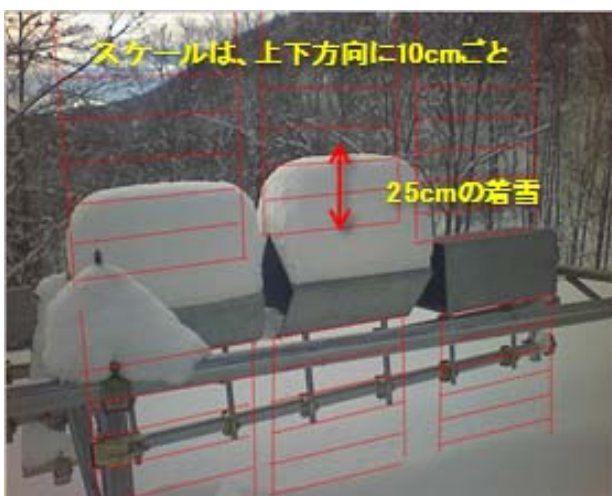
図 - 3 着雪量(高さ)の計測方法
