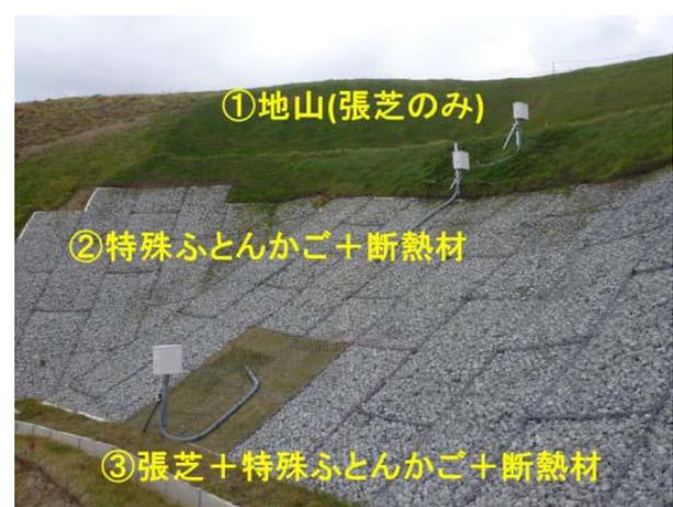
写真-11 試験施工の状況写真
