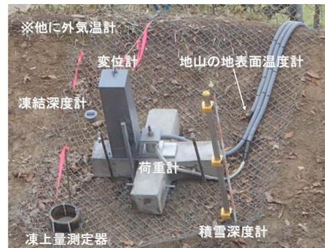
写真-4 白糠②の計測器の設置状況
