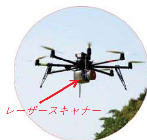
飛行型 (レーザースキャナ搭載)
