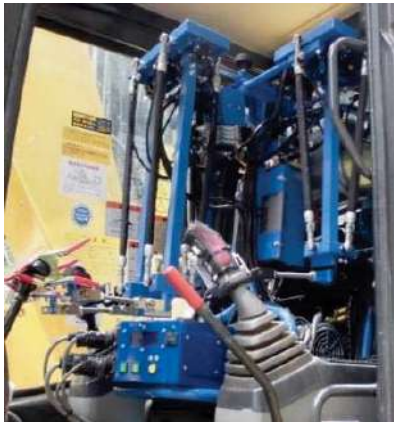
～空気圧駆動式ラバーアクチュエータによる汎用建機用遠隔操縦システム (コーワテック社)
