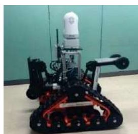
クローラー型 (被災トンネル調査)
