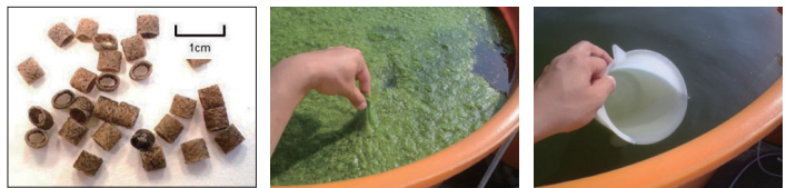
担体：中空筒状の樹脂に微生物を付着させたもの
