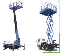
高所作業車 リフトフォーム式、シザーズ式 橋梁下部より確認
