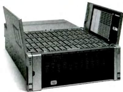
出典：CiscoのWebページより ストレージの例。写真はCisco UCS S ストレージサーバ
