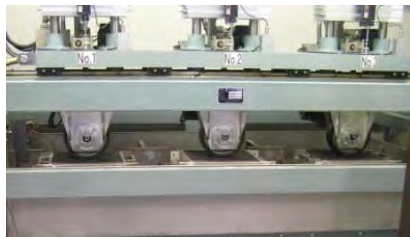
ホイールトラッキング試験状況
