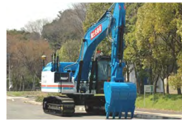
分解対応型バックホウ (無人化施工)
