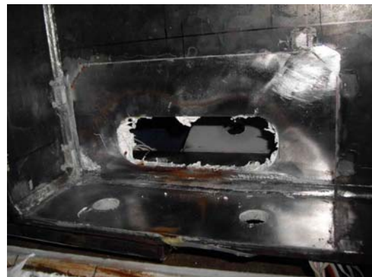
写真-7 水平交番载荷試験後の長孔の状況
