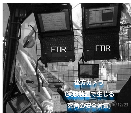
図-5 油圧ショベルに搭載した測定装置。 ( 転載元の図の一部をマスキングしている。)
