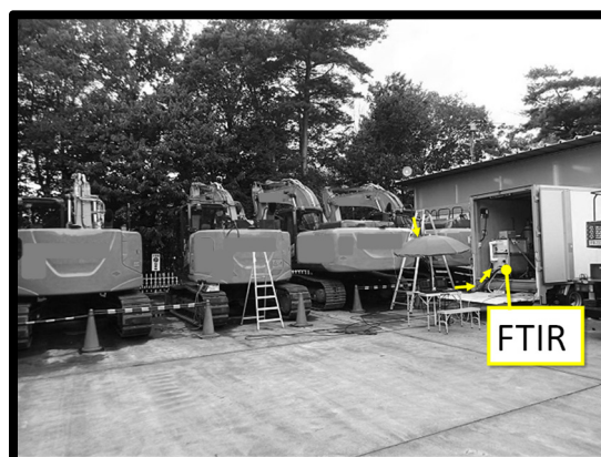
図-2.4 2018 年度の測定. 同一の敷地内で油圧ショベル 4 台を測定した。排出ガスは加熱導管で排気管からサンプルした。傘は日よけ。
