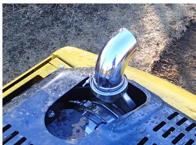
図-A.2.2 測定機器の写真。(1) 排気流量計用の直管とエンジンの排気管を接続するため製作した接続管。(2) FTIR の防振対策として設置したワイヤーロープ防振器。
