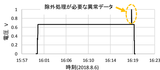
図-2.12 振動センサによるエンジン回転計の測定値の例.
