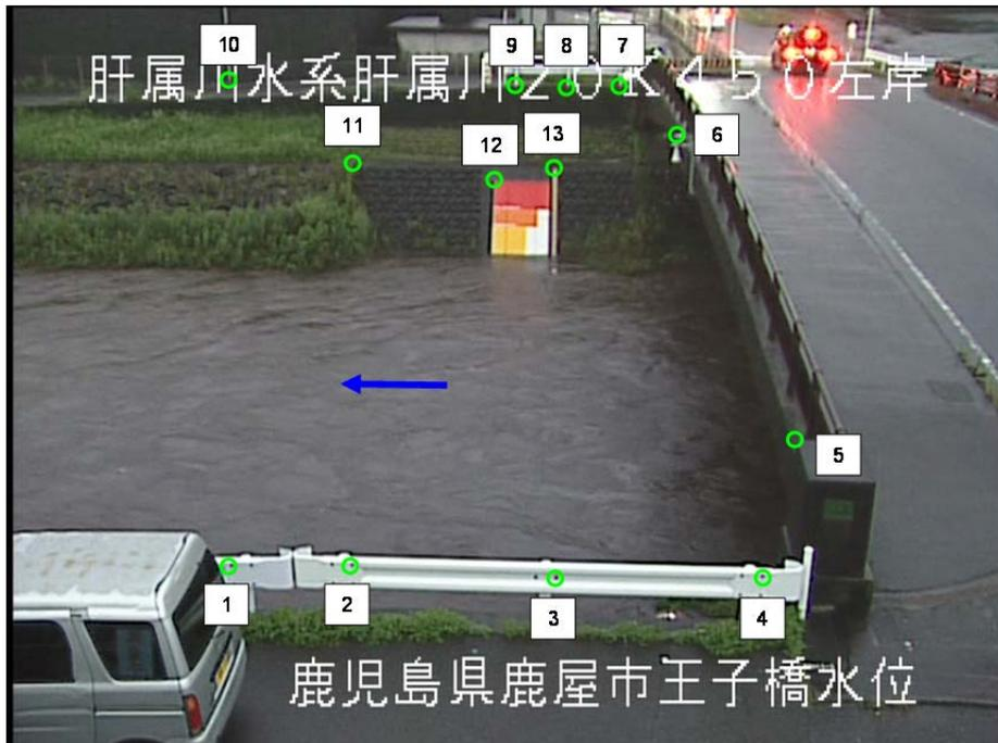
標定点をレンズの端（縁）ではなく、できるだけ中心部に配置した事例。レンズの歪みの影響を受けず、画像処理型流速測定法の実施が可能となる。
