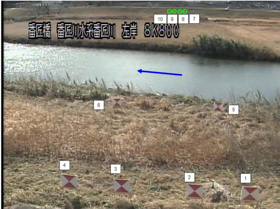
CCTV カメラ対岸の標定点 7～10（実際はベニヤ板で作成）はカメラから遠いことも要因であるが、レンズの歪みのため幾何補正精度が低い。堤防が湾曲していることから、CCTV カメラレンズの歪みを判断できる。
