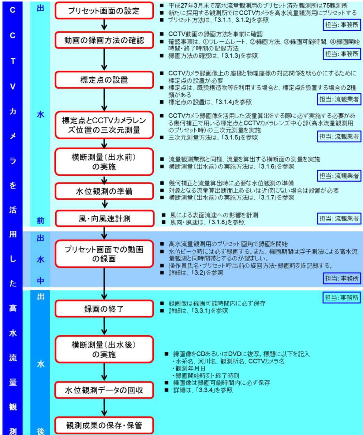
図5 「CCTVカメラを活用した高水流量観測」の実施フロー
