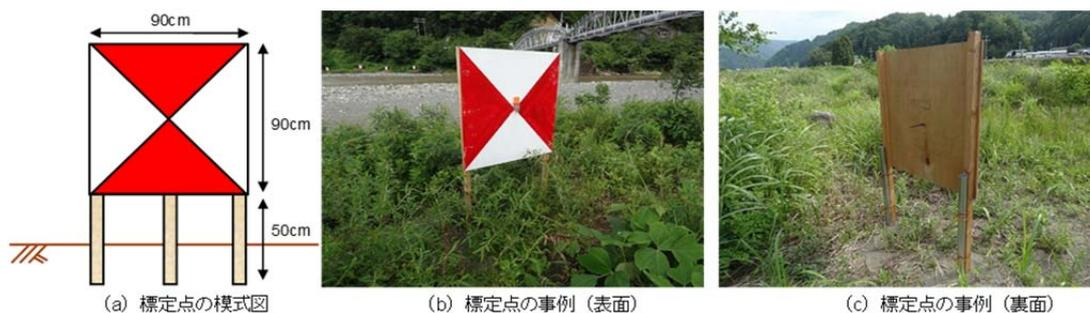
図 11 ベニヤ板で作成した標定点の例
