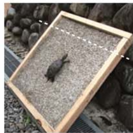
勾配は高さを1としたときの距離の割合で表し、2割、1.5割、1割、0.5割の順に勾配が急になります。
