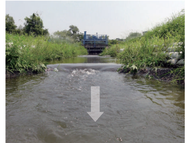
写真1 瀬淵工の大型模型実験
