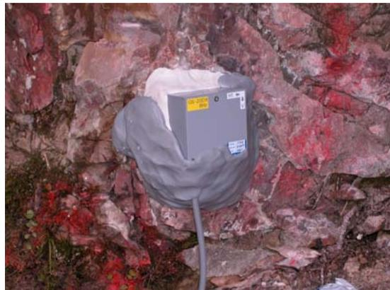
写真-3.3.1 小型振動計の事例
