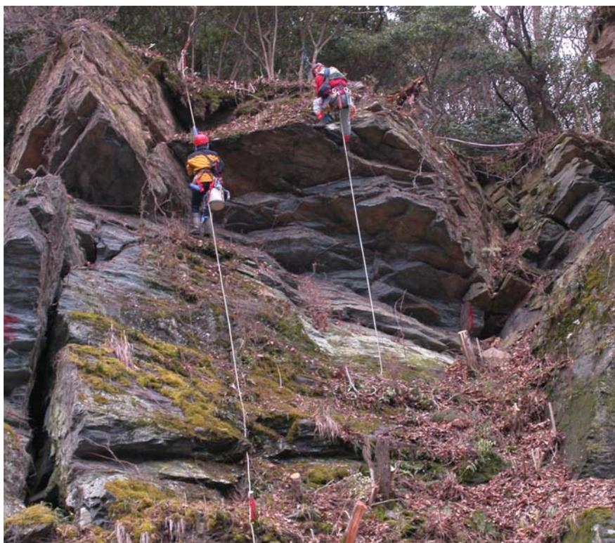
写真-3.3.2 ロッククライミングによる振動計の設置作業の事例
