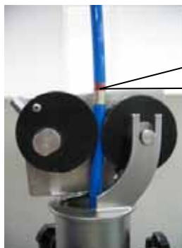
ケーブルのマーカー位置とホルダの位置関係 (応用地質(株)製)
