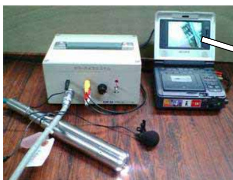
孔内カメラと開口亀裂の例
