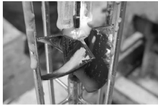
写真 3.5 試験後の羽の状況
