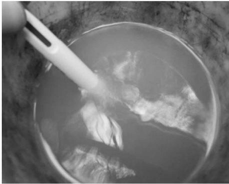
写真 3.4 洗浄時の戻り水の濁り状況
