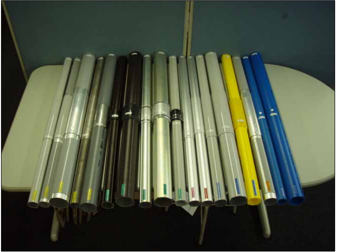
図-2-1-2-1 収集したガイドパイプ(全 18 種類/詳細は表-2-1-2-1)
